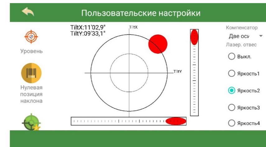
Если индикатор лазера справа показывает «выключено», это означает, что лазер выключен. Яркость от 1 до 4 означает, что лазер включен, и чем больше число, тем ярче лазер отвеса.
