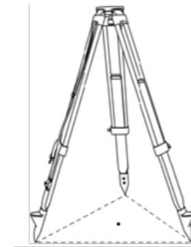
(1) Сначала установите штатив: выдвиньте телескопические ножки на необходимую длину и плотно затяните винты. Убедитесь, что ножки расположены на одинаковом расстоянии друг от друга, а головка штатива приблизительно выровнена по горизонтали. Установите штатив таким образом, чтобы головка находилась над точкой съемки. Убедитесь, что ножки штатива надежно зафиксированы в земле.
